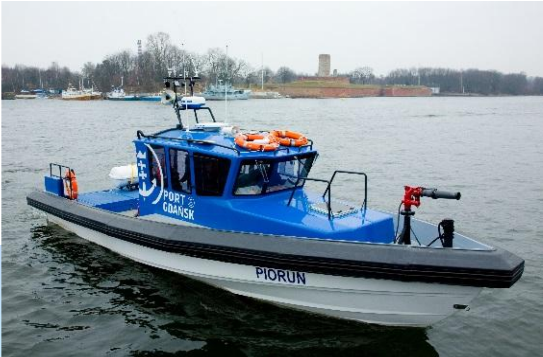
"PIORUN" Length: 11 m Width: 3,6 m Draft: 0,8 m Freeboard:1,9 m
